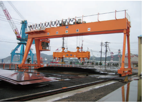
運転室付橋形クレーン
