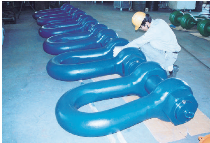
▲使用荷重800トン、世界最大級の鍛造シャックル
